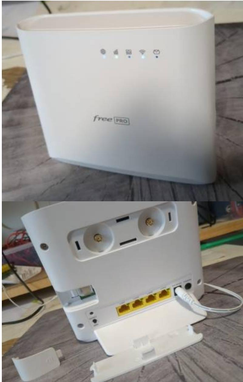
Ce modem 4G LTE fourni par Free dans le cadre de son offre Free-pro de modèle Zyxel LTE3202-M437 avec une SIM permettant de faire du failover de l'accès Fibre contient une configuration custom.
