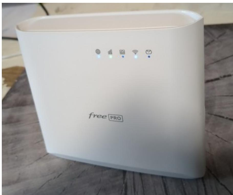
Ce modem 4G LTE fourni par Free dans le cadre de son offre Free-pro de modèle Zyxel LTE3202-M437 avec une SIM permettant de faire du failover de l'accès Fibre contient un configuration custom.
