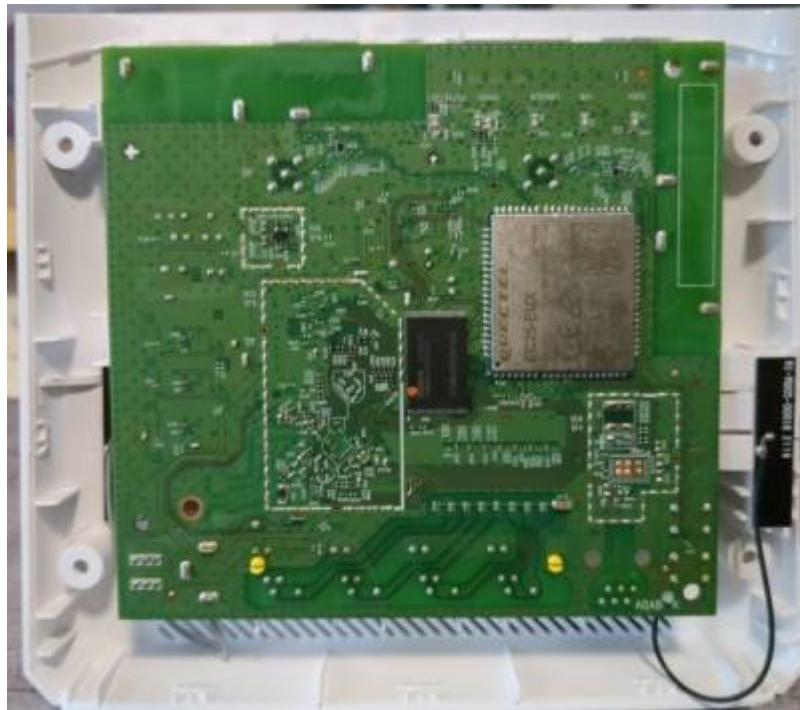
En testant avec un oscillo pour être sûr d'avoir le bon signal sur des points-test, on arrive à voir des choses qui bougent lors de l'allumage de l'appareil. On cherche une masse commune, et on test... et zou.
