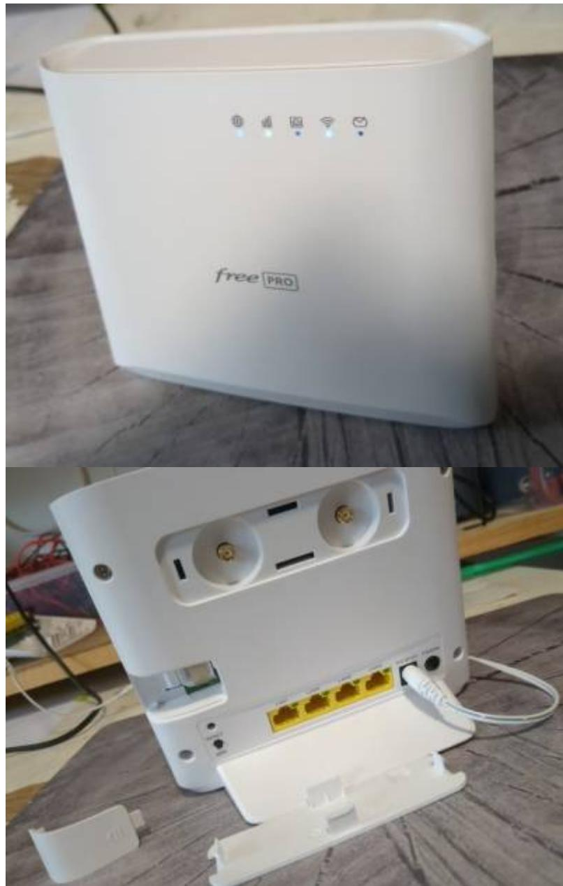
Ce modem 4G LTE fourni par Free dans le cadre de son offre Free-pro de modèle Zyxel LTE3202-M437 avec une SIM permettant de faire du failover de l'accès Fibre contient un configuration custom.
