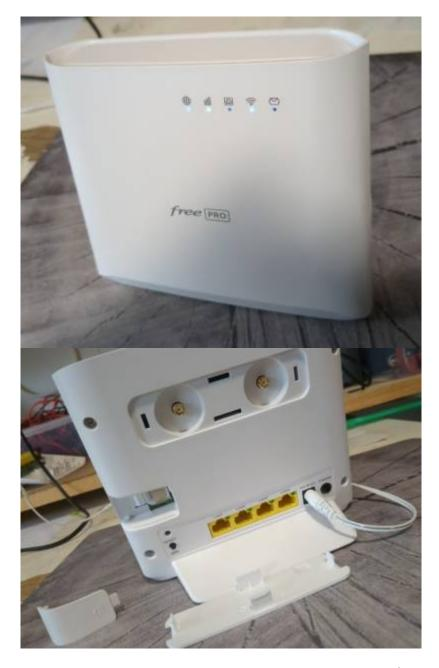
Ce modem 4G LTE fourni par Free dans le cadre de son offre Free-pro de modèle Zyxel LTE3202-M437 avec une SIM permettant de faire du failover de l'accès Fibre contient un configuration custom.
