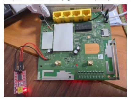
Un patte pour le RX, une pour le TX, et une pour la masse. Inverser les pattes RX et TX si jamais ça marche pas ;) et zou
